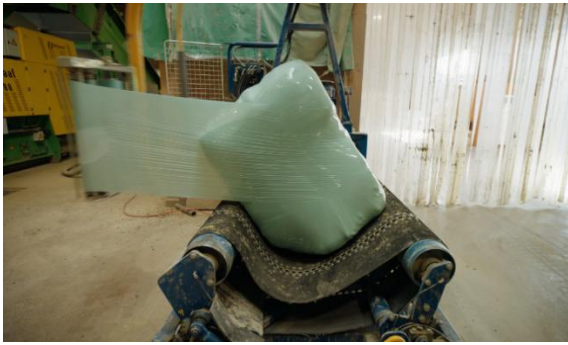
Bild 4: Gepresste KMF-Ballen werden für den Transport und die Deponierung sicher einfoliert.
